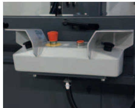
Zweihand-Sicherheitsbedienung anstelle einer Schutzhaube.
