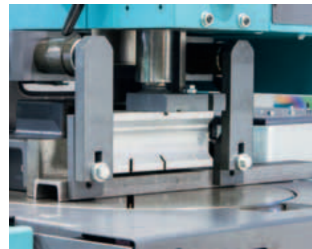
Horizontalspannstock rechts und/oder links vom Sägeblatt.
