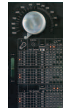
Hydraulischer Sägeblatt-Vorschub. Nach Tabelle stufenlos einstellbar.
