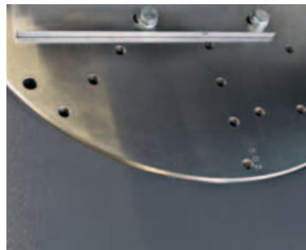
Bohrbild im Sägetisch zur Aufnahme von kundenspezifischen Vorrichtungen.
