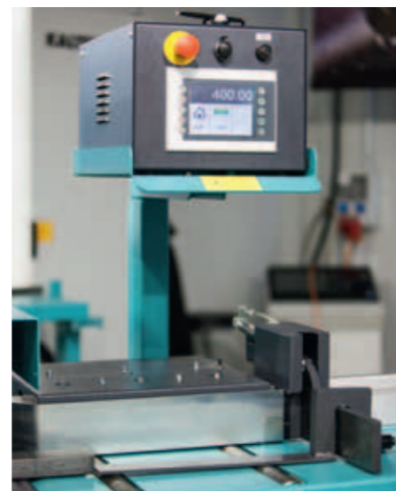
Universalkreissäge mit Längensmesssystem L 41 NC und T3 Zufuhrrollenbahn.
