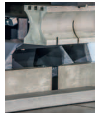
Werkstückanschlag beidseitig vom Sägeblatt.
