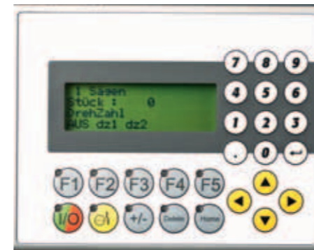
Eingabe- und Diagnosepanel zur Bedienung und Programmierung.
