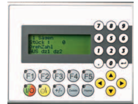
Eingabe- und Diagnosepanel zur Bedienung und Programmierung.
