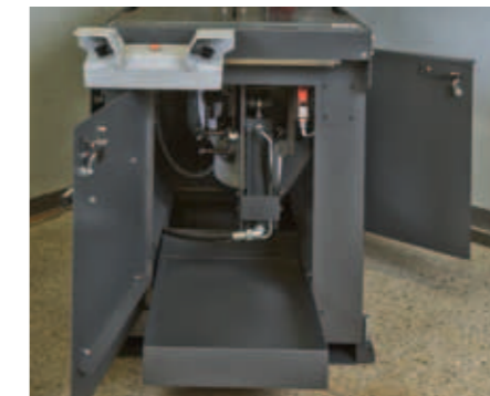
Gute Zugänglichkeit für Blattwechsel und Wartungsarbeiten.
