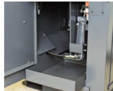
Große Fronttür für leichten Zugang zum Sägeblattwechsel und zur Späneentsorgung.
